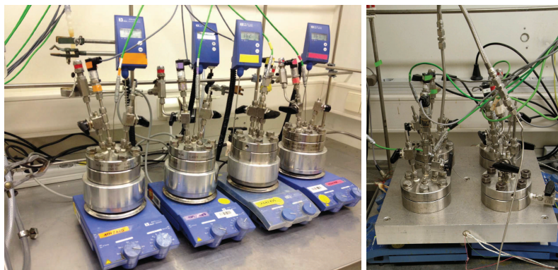
Abbildung 7.73.: Die beiden verwendeten Hochdruckteststände mit jeweils vier Autoklaven
