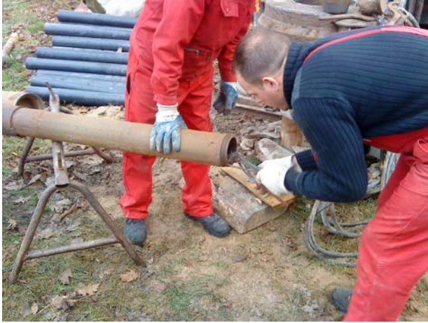
Abbildung 3-2: Entnahme des Probenliners aus der Schlagvorrichtung. Im Hintergrund: PE-DN 100 Liner
