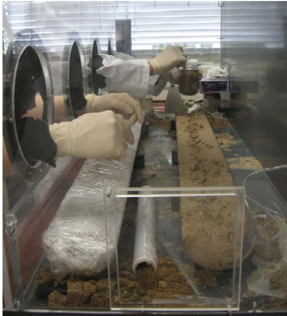
Abbildung 3-5: Entnahme von Feststoffproben aus der Mitte der geöffneten Liner unter Argonatmosphäre (aus Salm, 2010, unv. )
