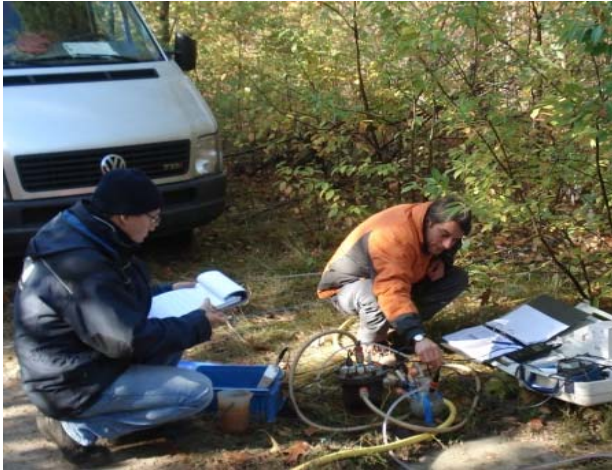
Abbildung 3-7: Sondenmessung in Durchflusszelle
