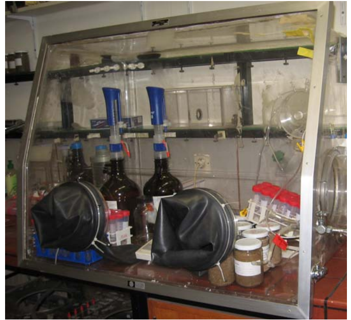
Abbildung 3-6: Glovebox mit Dosiervorrichtungen zur Eluat-Herstellung unter Inertbedingungen durch Argon (aus Salm, 2010, unv. )
