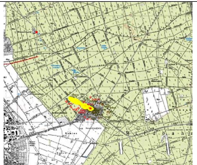
Abbildung 2-10: Prognostizierte Schadstoffausbreitung in 60 Jahren mit hydraulischer Sicherung
