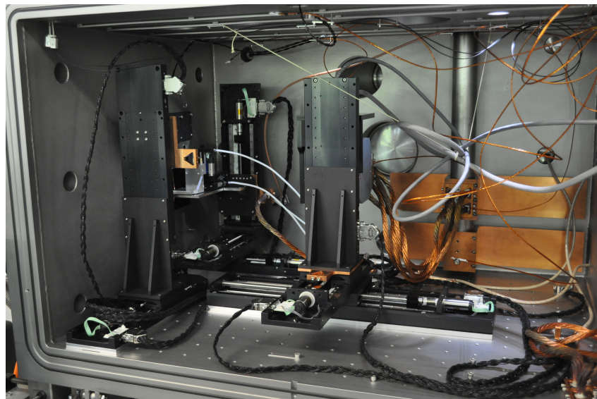
Abbildung 2.5.: Blick ins Innere der Vakuumkammer HORST. Der Boden der Kammer ist ein optischer Tisch, der es erlaubt, die Geometrie des Experimentaufbaus unterschiedlichen Experimenten anzupassen. Dank motorisierter Verfahrtschienen ist es möglich, die verschiedenen Komponenten auch im evakuierten Zustand zu bewegen und so beispielsweise den Abstand und die Ausrichtung des Detektors zu verändern.
