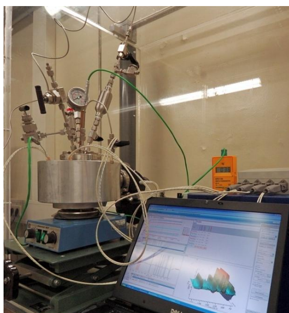
Abbildung 5-1: Der in situ Autoklav mit ReactIR 45 m und angeschlossenem PC .
