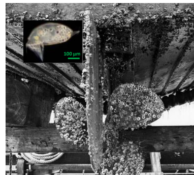
Abbildung 1. A. Mit Algen bewachsene Schiffshülle und eingefärbtes Elektronenmikroskopiebild von Sporen der Grünalge Ulva linza . B. Mit Seepocken bewachsener Schiffsrumpf und lichtmikroskopische Aufnahme einer Seepockenlarve. 5-6
