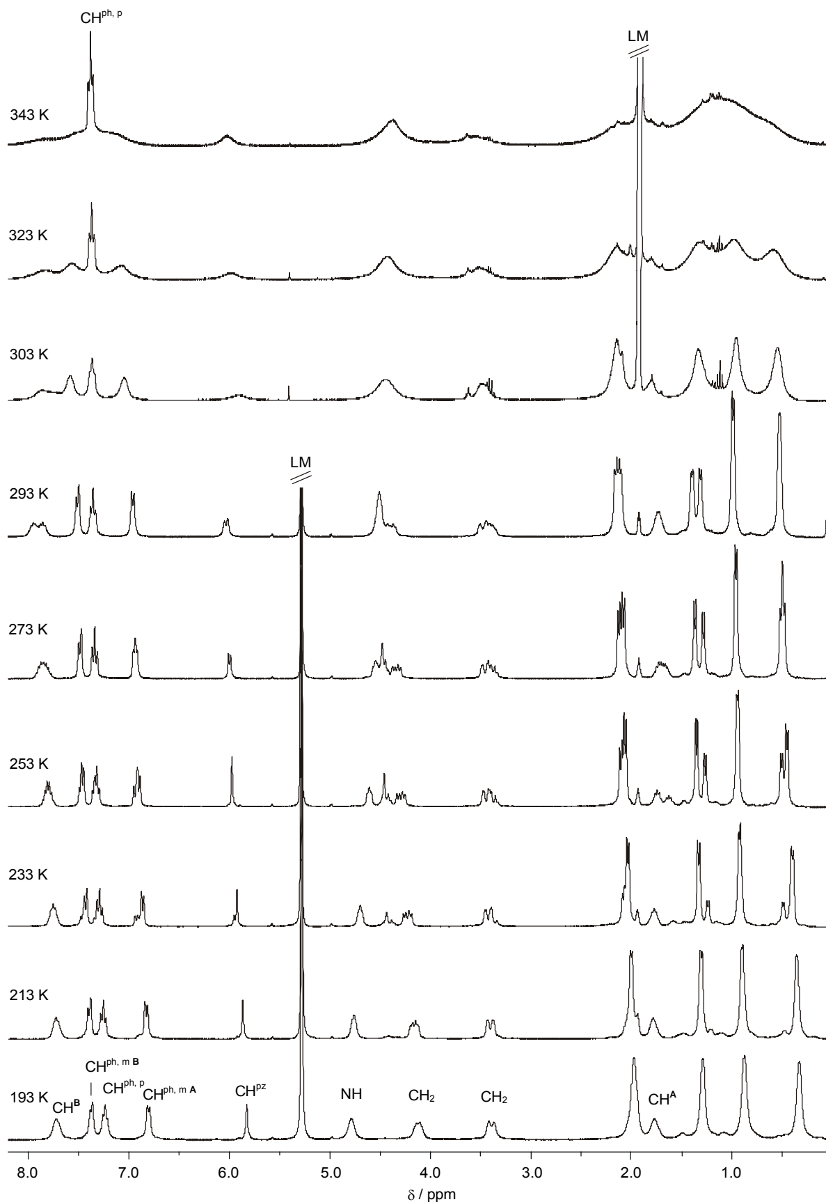
Abb. 3.2.2.4.5: Temperaturabhängige ^1\text{H} NMR-Spektren von [\text{L}_2\text{Ni}_2](\text{ClO}_4)_2 (9) in \text{CD}_3\text{CN} (303 K – 343 K) und \text{CD}_2\text{Cl}_2 (193 – 293 K), die Zuordnung der Signale entspricht Abb. 3.2.2.4.3.
