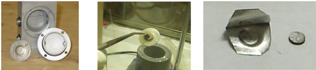
Abbildung 4.1.: Target und Targethalter vor der Bestrahlung (links) und nach der Bestrahlung (mitte und rechts)
