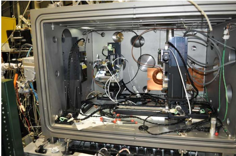
Abbildung 27: Blick ins Innere der Röntgenstreuammer HORST beim Aufbau am Synchrotron. Zu sehen ist das 2. Probenhalterdesign (Nahaufnahme in Abbildung 28).
