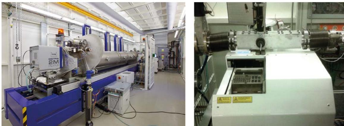
**Abbildung 25:** Bilder des BioSAXS-Strahlrohrs P12 bei PETRA III, Hamburg, Deutschland. Links: Blick auf den Detektor und das evakuierte Flugrohr. Rechts: Der Probenroboter für die Hochdurchsatzanalyse.
