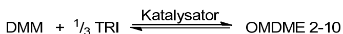
Schema 33. Reaktionsgleichung der OMDME-Synthese mit dem in den Versuchen meist eingesetztem molaren TRI/DMM-Verhältnis.
