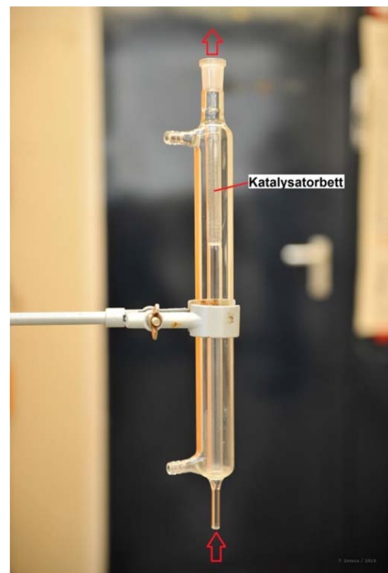
Abbildung 20: Zeichnung des Glasrohrreaktors (links, P1 = HPLC-Pumpe, TI = Messung der Temperatur mittels NiCr-Ni-Thermoelement), Photographie des Glasrohrreaktors (rechts).
