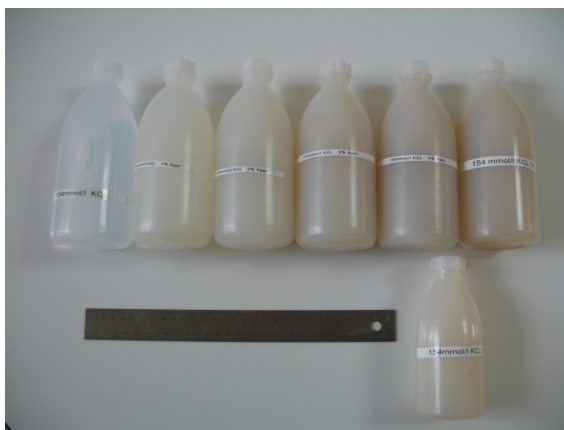
Abbildung 3.3: Phantome Phantomflaschen mit 154 \text{ mmol/l} KCl sowie unterschiedlichen Agar-konzentrationen zwischen 0 % und 5 %. Das Agar erhöht die Viskosität der Phantomfüllung und schränkt so die Kaliumionen in ihrer brownischen Bewegung ein. Hierdurch wird die Korrelationszeit des Systems im Vergleich zur wässrigen Lösung verringert, was zu kürzeren und für 3/2 -Kerne zu bi-exponentiellen Relaxationseigenschaften führt.
