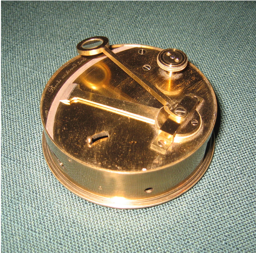
Fig. 35. Dosensexant von Banks (London). Detail-Aufnahme. Privatbesitz der Autoren.
