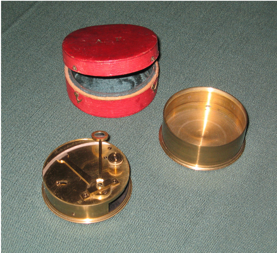
Fig. 34. Dosensexant von Banks (London) mit Schraubdeckel und lederbezogener Schatulle. Privatbesitz der Autoren.
