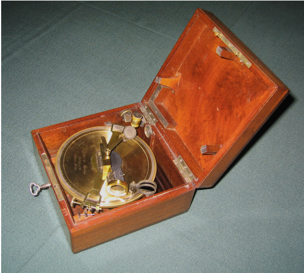
Fig. 36. Reflexionskreis von Pistor und Martins (Berlin, Nr. 174) in seinem Aufbewahrungskasten. Privatbesitz der Autoren.
