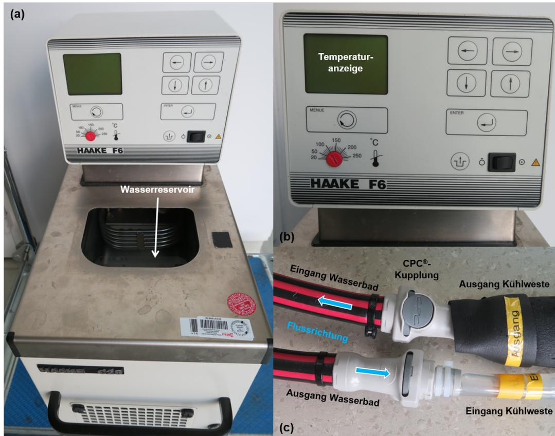
**Abbildung 3.9:** Das Wasserbad mit Wasserreservoir (a) und dem Bedienfeld mit Temperaturanzeige zur Einstellung der Wassertemperatur (b). In dieser Arbeit wurde das Wasserbad über einen Computer angesteuert. Mittels Schnellverschlusskupplungen lässt sich eine Schlauchverlängerung zur Kühlweste anschließen. Die Wasserflussrichtung ist mit blauen Pfeilen gekennzeichnet.
