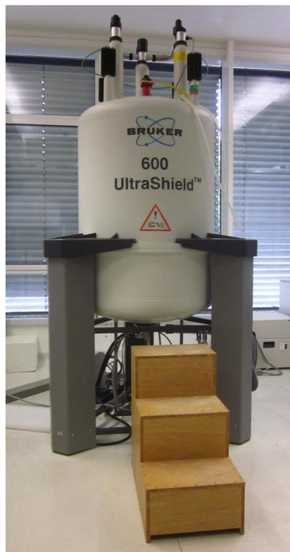
**Abbildung 3.1:** Das 14,1 Tesla NMR-Spektrometer am Deutschen Krebsforschungszentrum in Heidelberg. Die Abbildung wurde mit freundlicher Genehmigung aus Quelle [59] zur Verfügung gestellt.
