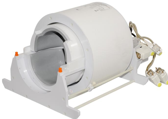
**Abbildung 3.4:** Die 24-Kanal-Kopfspule der Firma Nova Medical wurde für die *in vitro* Messungen verwendet (Grafik mit freundlicher Genehmigung entnommen aus Quelle [63]).
