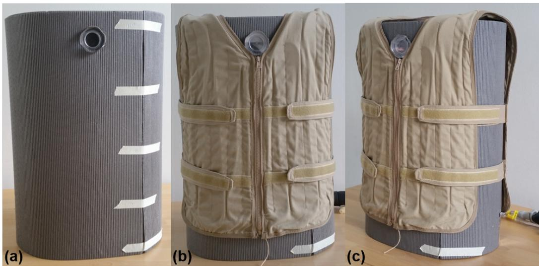
**Abbildung 3.14:** (a) Zweifach mit Isolationsmaterial umwickeltes Thoraxphantom. Als Nullmessung zur Bestimmung des Wärmeübertrags zwischen Phantom und Umgebung wurde das identische Messprotokoll durchgeführt. Dazu wurde die Kühlweste an das Thoraxphantom angebracht (b,c).
