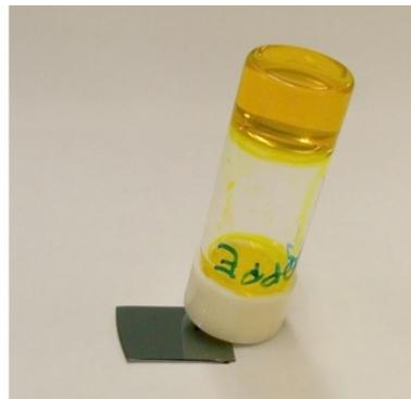
**Abbildung 6:** 3 mg eines Alkoxy-PPEs, das in Toluol gelöst wurde und nach einem Tag vollständig geliert war. Durch leichtes Erwärmen konnte das Gel wieder verflüssigt werden.
