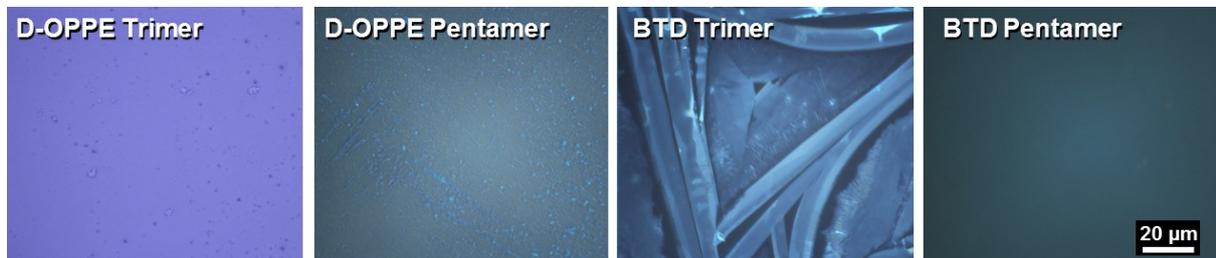
**Abbildung 125:** Polarisationsmikroskopaufnahmen von ungetemperten OPE-Filmen.
