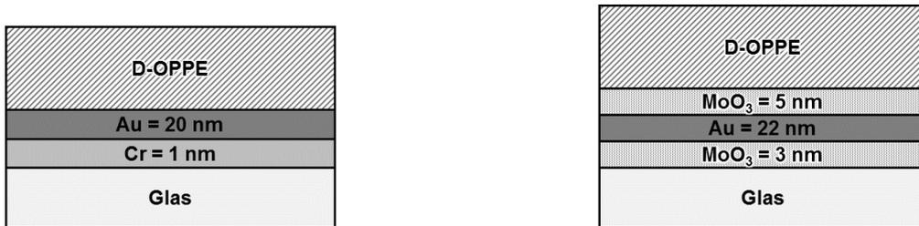
**Abbildung 89:** Schematischer Aufbau der XPS und UPS Proben.
