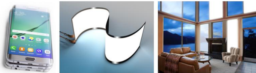
Abbildung 1: Anwendungen von OLEDs: Rechts: Smartphone von Samsung mit OLED-Display, mitte: Flexibles OLED-Panel von LG Electronics, rechts: Designstudie „transparente OLED-Fenster“ von OSRAM. 1
