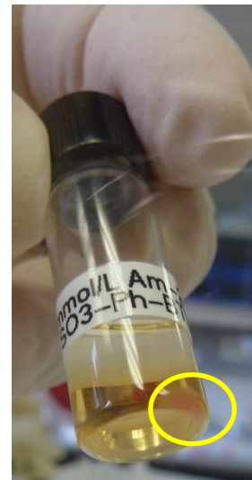
Abbildung 61 links: Verteilungsverhältnis von Am(III) als Funktion der absorbierten Dosis. Organische Phase: 2.5 mmol/L ^{243}\text{Am(III)} , 0.2 mol/L TODGA in Exxsol D 80 + 5% vol. Octanol. Wässrige Phase: 20 mmol/L \text{SO}_3\text{-Ph-BTBP} in 0.36 mol/L \text{HNO}_3 , A/O = 1, T = 293 K. Rechts: Fotografie des alpha-Radiolyseexperiments nach Bildung eines Niederschlags.
