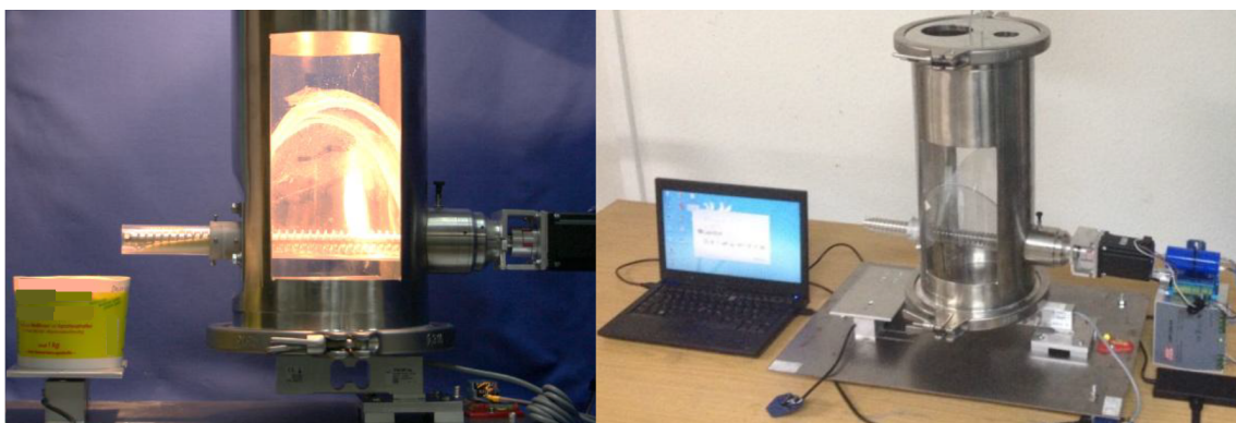
Abbildung 2.1: Aufbau der Dosierwaage mit Schraube und Messzubehör.
