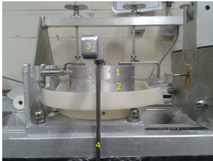
Abbildung 2.6: Aufbau der Jenike Scherzelle. Zu erkennen sind die beiden Ringe (1, 2) und der Bügel (3), über welchem Gewichte zur Definition der Normalspannung eingehängt werden (4).
