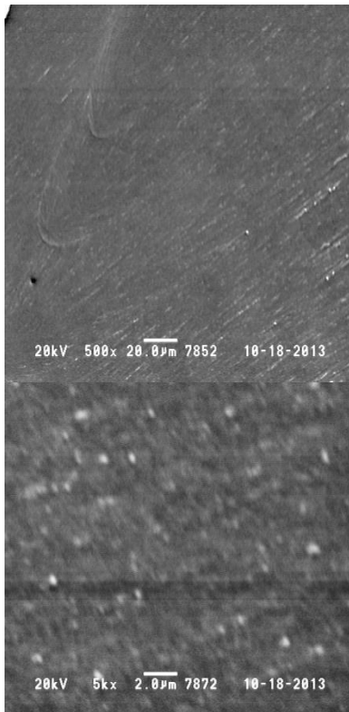
Abbildung 60: REM-Aufnahmen von Proben des Systems DGEBA/DMDC/PolyTHF®650 (10 w%), bei denen unterschiedliche Härtungszyklen angewendet wurden.
