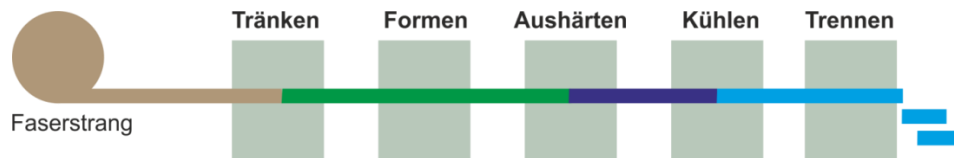
Abbildung 8: Das Prinzip der Pultrusion [18].
