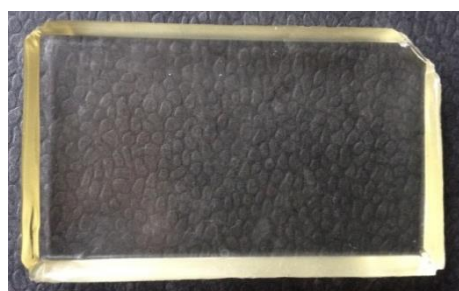
Abbildung 61: REM-Aufnahmen von Proben des Systems DGEBA/DMDC/PolyTHF® 650 mit unterschiedlichen Gewichtsanteilen des Modifiers und eine Fotoaufnahme ausgehärteten Harzprobe DGEBA/DMDC/PolyTHF® 650 (repräsentativ für alle getesteten Anteile).
