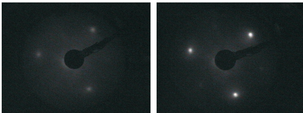
Abb. 4.10: LEED-Bilder eines Cu(111)-Einkristalls. Auf der linken Seite ist das Bild des unbehandelten Kristalls, auf der rechten Seite das Bild nach acht Sputter-Heiz-Zyklen. Beide Bilder wurden mit einer Energie von jeweils etwa 122\text{ eV} aufgenommen.
