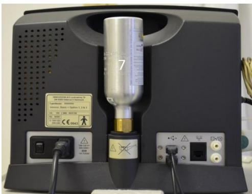
Abbildung 4: Innocor® Messgerät - Gasflasche
