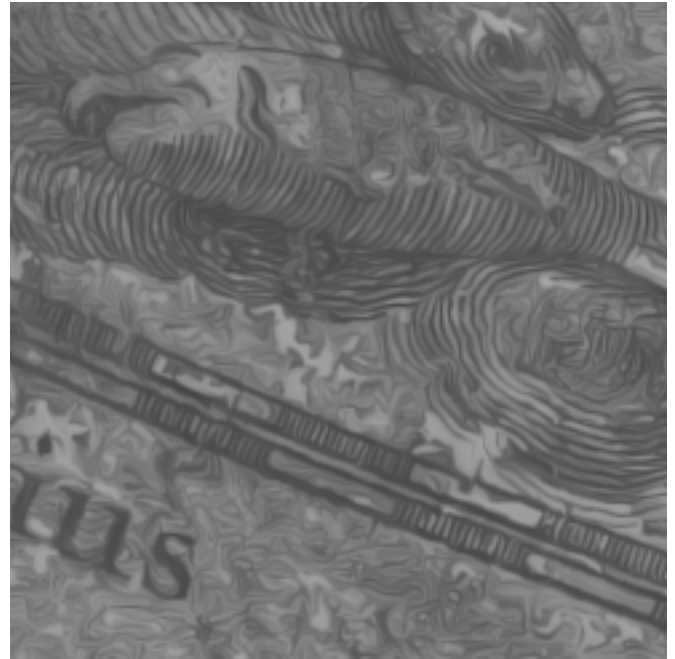
Abb. 4: Resultat nach Anwendung des Filterverfahrens. Nichtlineare, inhomogene Diffusionsfilter glätten die geringen Unterschiede und verstärken die großen. Koppelt man sie darüberhinaus an einen Strukturtensor, so kann die Orientierung der Grauwertänderung in die Bewertung des Bildpunktes einbezogen werden. Das Ergebnis ist ein entlang vorhandener Strukturen zerflossenes Graubild.
