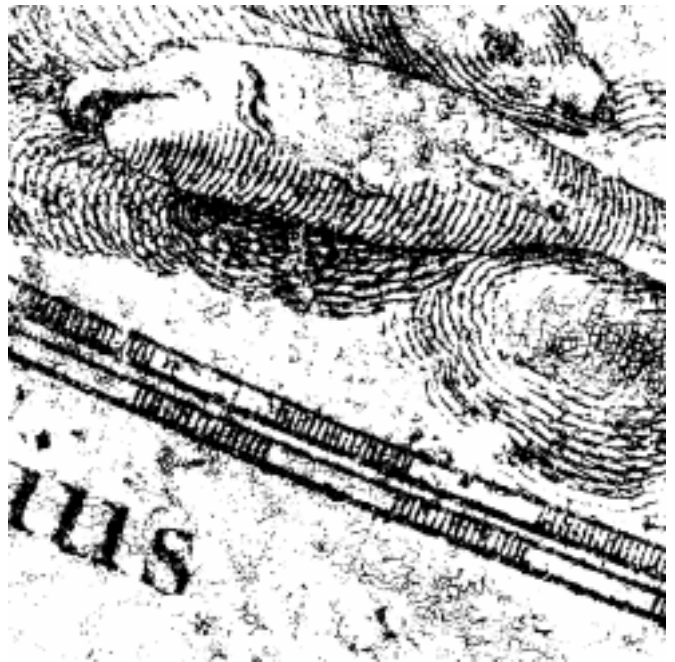
Abb. 6: Ausschnitt des Originals nach der Tontrennung. In dieser Vergrößerung wird deutlich, daß eine selbst mit optimalem Schwellwert durchgeführte Tontrennung des digitalisierten Originals viele unerwünschte, geschwärzte Strukturen aufweist, die beim Gesamteindruck einen unregelmäßigen Grauschleier erzeugen würden.
