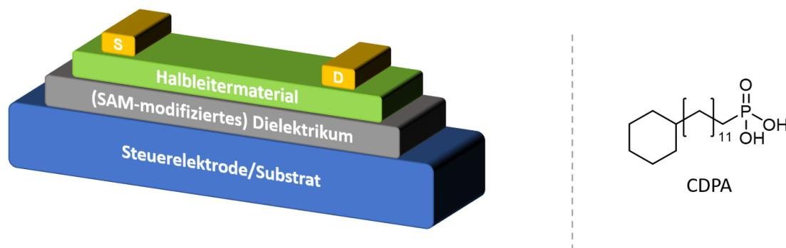
Abbildung 5. Links: Schematischer Aufbau der fabrizierten OFET-Devices in der in dieser Arbeit verwendeten BG/TC Architektur. Rechts: Strukturformel des SAM-Materials Cyclohexyldodecylphosphonsäure (CDPA).
