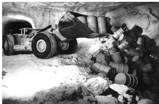
Abb. 2-5: Zu Versuchszwecken werden im Forschungsbergwerk Asse Fässer über eine Halde abgekippt. Foto: GSF Forschungszentrum für Umwelt und Gesundheit.
