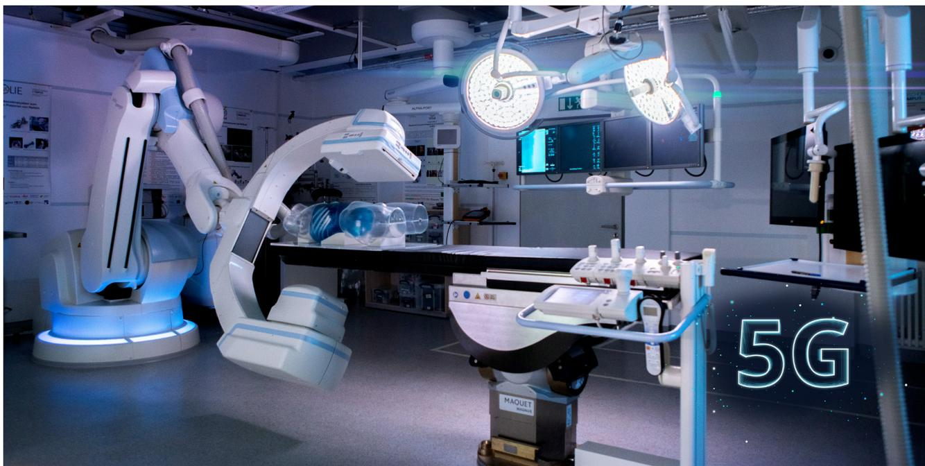
Abbildung 6: Der experimentelle Hybrid-OP ermöglicht die Entwicklung, Erprobung und das Training von Technologien und Prozessen in einem simulierten Operationsaal. Neben der Bildgebung, dem Anschluss an ein entsprechendes PACS, funktionalen Phantomen, der Bild- und Tonübertragung und einem direktem Zugang zu Biolaboren, verfügt das Reallabor auch über eine moderne 5G-Infrastruktur.
