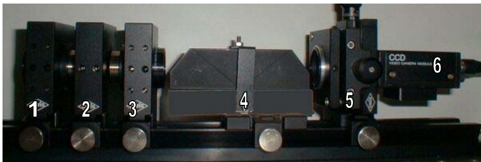
Abb.5.2.2: Prismenmonochromator des ortsaufgelösten CCD-Spektrometers: 1,3,5 - Objektiv (Brennweite f=35 mm); 2 - Präzision-Spektralspalt ( 10\ \mu\text{m} Breite); 4 - Geradsichtprisma Amichi; 5 - CCD-Kamera.
