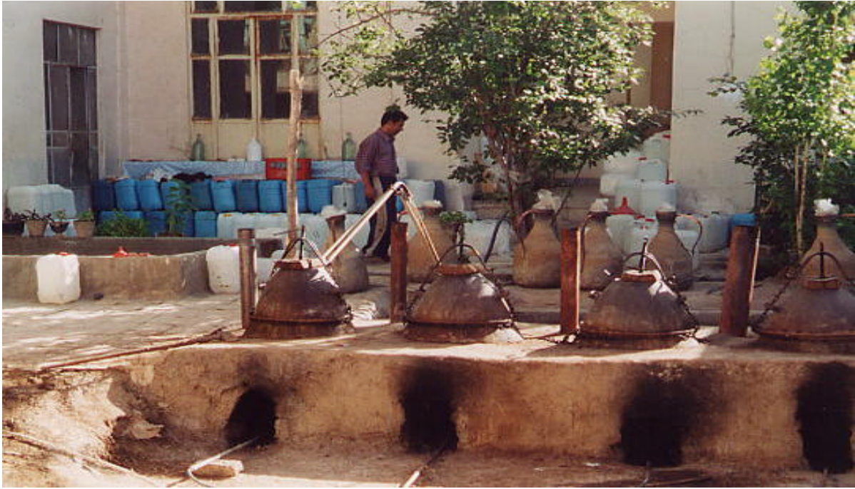
Abb. 39 KUREHAE GOLABGIRIE (so der Name der Öfen, welche die Destillationskessel beheizen)
