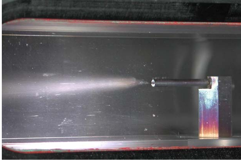
Abb. 6.20. Kanal mit Düse bei laufendem Betrieb. Man erkennt sehr gut die Phasen des Sprayaufbruchs: zunächst laminarer Flüssigkeitsstrahl, Ausbildung von Ligamenten und schließlich Zerstäubung. Die Strömung verläuft von rechts nach links.
