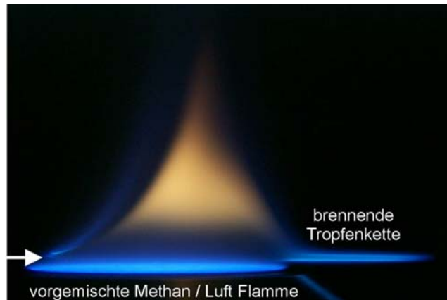
Abb. 5.6. Tropfenkette im heißen Abgas einer stöchiometrischen Methan-Luft-Flamme. Der Pfeil links deutet den Eintritt der Tropfenkette in den Abgasbereich an.
