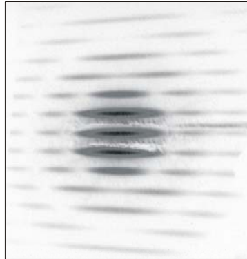
Abb. 3.10. Fotografie des Interferenzmusters der monodispersen Tropfenkette. Das Licht eines Helium-Neon-Lasers wurde auf die Kette fokussiert ( f = 300 mm) und auf einem Schirm in 3,5 m Entfernung beobachtet. Das ringförmige Muster entsteht durch Streuung an (sphärischen) Tropfen, das überlagerte Streifenmuster durch Interferenzen, da die äquidistanten Tropfen wie ein Beugungsgitter wirken.
