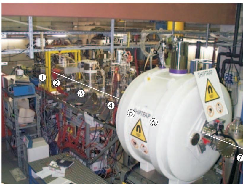
Abbildung 4.3: Photo des SHIPTRAP-Experiments mit den Elementen: Gaszelle (1) mit Extraktions-RFQ (2), Buncher-RFQ (3), verschiebbare Detektor-Ionenquellen-Einheit (4), supraleitender Magnet mit Reinigungsfalle (5) und Präzisionsfalle (6) und MCP-Detektor (7).
