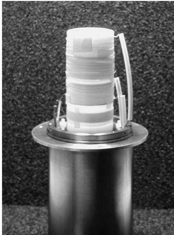
Abbildung 4.16: Supraleitende Nachweisinduktivität bestehend aus einer Spule (Niob–Titan–Draht, NbTi) und einem Resonatorgehäuse aus Nb–Ti. Das Foto zeigt die Spule auf dem Gehäuse stehend. Die Primär- und Sekundärwicklungen der Spule sind auf einen Teflonkern aufgebracht und gegen Verrutschen fixiert.
