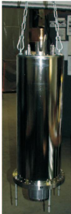
Abbildung 4.10: Helium-Dewar nach der Fertigung. Die äußeren Abmessungen des Dewars betragen AD = 250 mm und  $L = 760$  mm. Der Raum für den Einsatz der supraleitenden Nachweispule ragt über den unteren Rand des Dewars in die benachbarte Vakuumkammer hinein.
