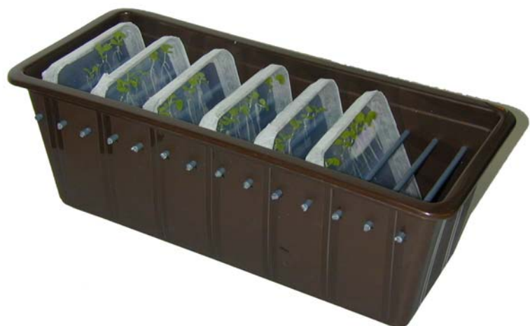
Abb. 4.1: Petrischalenhalter zur Kultivierung der steril auf Agar angezogenen Pflanzen
