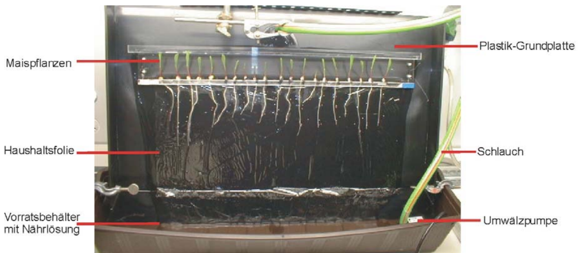
Abb. 4.2: Maiskeimlinge im Durchfluss-Rhizotron (ohne schwarze Abdeckfolie; aus Nagel 2003)
