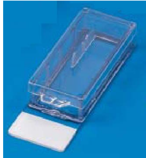
Abb. 4.3: Chamberslide für die Anzucht von Arabidopsis -Pflanzen für die Beobachtung mit dem CLSM verwendet
