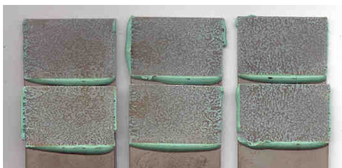
Abb. 4.21. Kohäsives Versagen beim Toplayer-System 5 \mu\text{m} Zn + 1 \mu\text{m} Zn/Mn (75/25).
