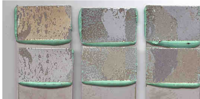
Abb. 4.22. Adhäsives Versagen beim Toplayer-System 5 \mu\text{m} Zn + 1 \mu\text{m} Zn/Mn (75/25).
