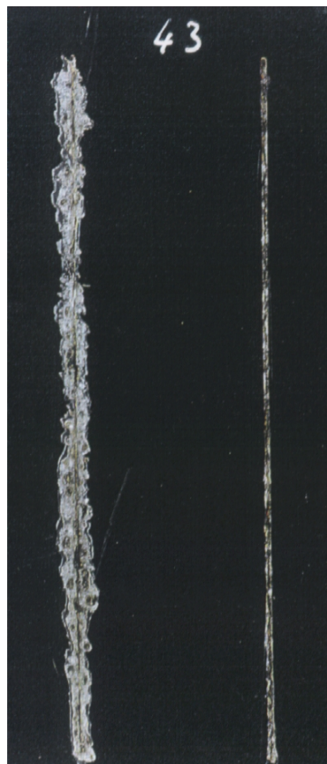
Abb. 4.6. Beispiel einer lackierten Probe im VDA-Wechseltest: Schichtsystem 5 \mu\text{m Zn} + 1 \mu\text{m Zn/Mn (75/25)} nach 10 Zyklen. Links: Prüfung auf Unterrostung durch Ablösen der Lackschicht. Rechts: Erscheinungsbild des Ritzes nach dem Test, Unterrostung ist ohne Lackentfernung nicht erkennbar. Die Abbildung ist nicht maßstabsgetreu.
