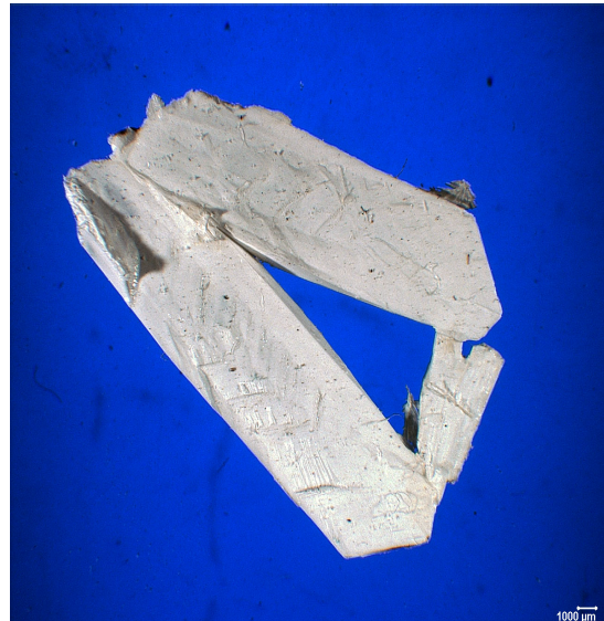
Abb. 10-10: \gamma -Butyrolacton/RT Leistenförmiger Mischkristall.
