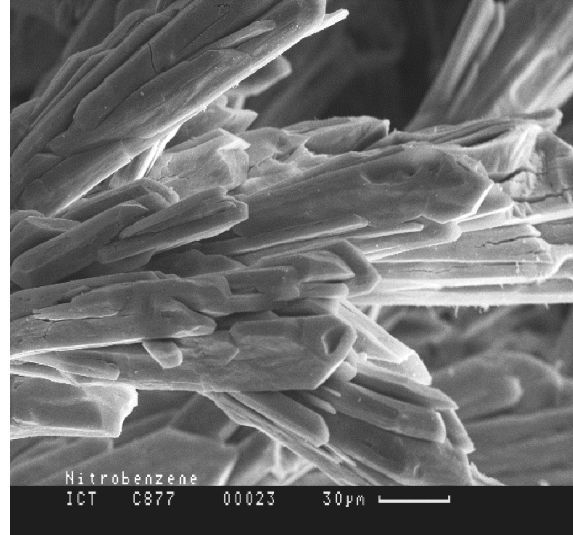
Abb. 10-22: Nitrobenzol/RT HNIW-Nadeln, vergrößerter Ausschnitt von Abb. 10-21.
