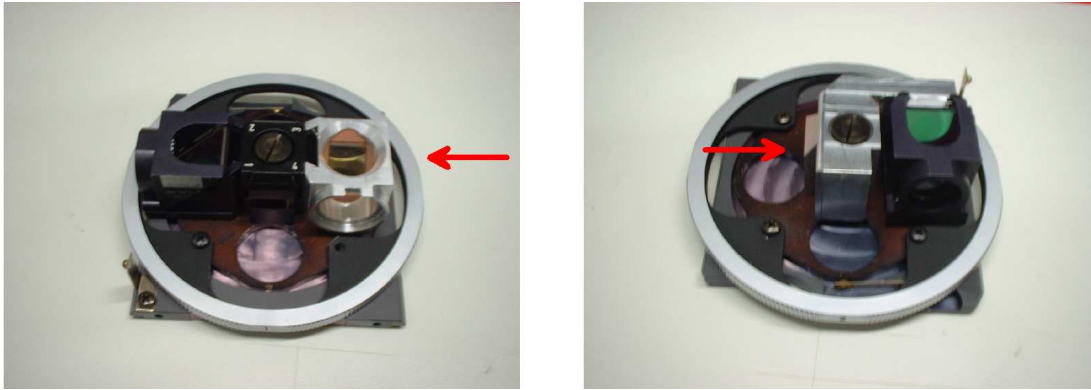
Abbildung 9.3: Modifikationen des Fluoreszenzfilterrads zur Nutzung des TIRFM-Moduls: Im linken Panel rechts der Strahlteilereinsatz für parallele TIRFM- / Konfokalanwendungen, im rechten Panel der Filtersatzhalter, mit dem vorhandene Fluoreszenzfiltersätze im TIRF-Modus verwendet werden können.
