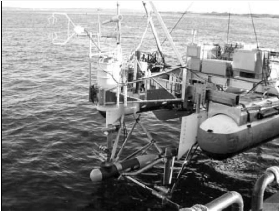
Abbildung 8.1: Katamaran 'LADAS' während dem Aussetzen im Nord Atlantik. Mit der am Bug montierten *laser slope gauge* [BOCK 1999] wird die Neigung der Kapillarwellen auf der Ozeanoberfläche gemessen.
