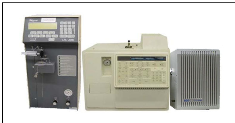
Abb. 8.2. : Purge & Trap GC-MS
