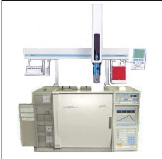
Abb. 8.1. : GC-ECD mit Kombi PAL Autosampler
