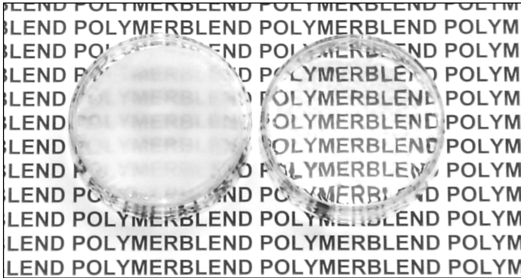
Abb. 4.9 Polymerblends aus Polyimid und Polyvinylpyrrolidon, links 6FDA-4MPD / PVP; rechts 6FDA-4MPD/DABA 19:1 / PVP
