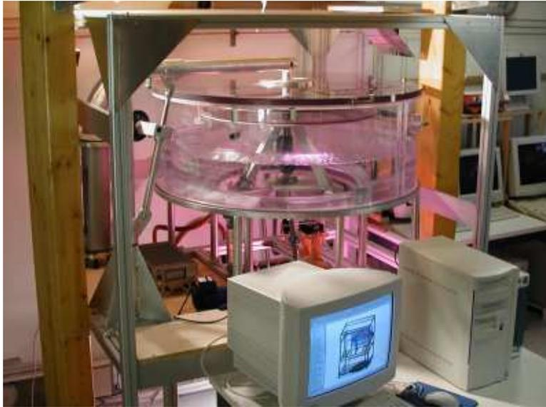
**Abbildung 1.4:** Kleiner Wind-Wellen-Kanal der Universität Heidelberg. Der zirkuläre Kanal hat einen Durchmesser von 1.2 m und eine Rinnenbreite von 20 cm. Hieran wurden alle in dieser Arbeit dargestellten Experimente durchgeführt.
