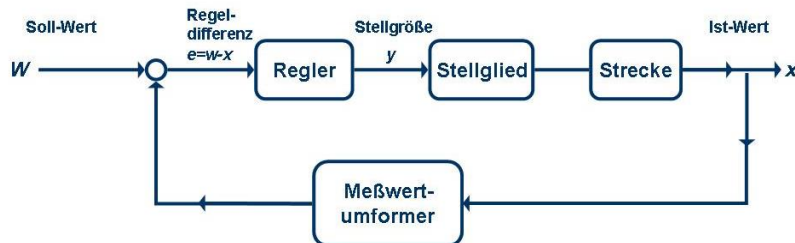
Abbildung 135: „Blockschaltbild eines Regelkreises“ 672
