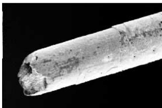
(d) Gerissener Draht. Man erkennt die Stufe, an der zuerst die Goldschicht weggeätzt wurde, bevor das Wolfram zutage trat.
