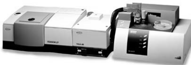
Abbildung 3.47 TG-FTIR- Messapparatur der Firmen Bruker und Netzsch (Quelle: Homepage der Firma Bruker). Zu sehen sind Thermowaage (rechts) und Infrarotspektrometer (links)
