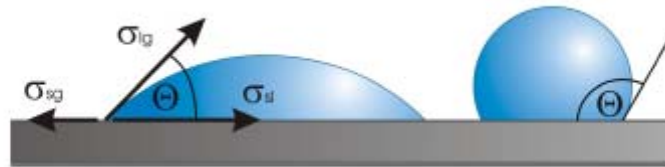
Abb. 20: Kontaktwinkel eines auf einer Festkörperoberfläche aufliegenden Wassertropfens [45]. links: hydrophile Oberfläche (kleiner Kontaktwinkel); rechts: hydrophobe Oberfläche (großer Kontaktwinkel)
