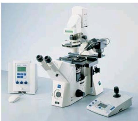
**Abb.3.23:** Halbautomatisierte Mikroinjektionssystem für adhärenente Zellen.
