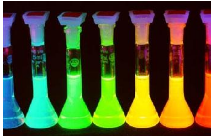
Abbildung 2.15: Abhängigkeit der Emission von der Größe des Halbleiterkerns, mit zunehmender Größe verschiebt sich die Emission zu längeren Wellenlängen.
