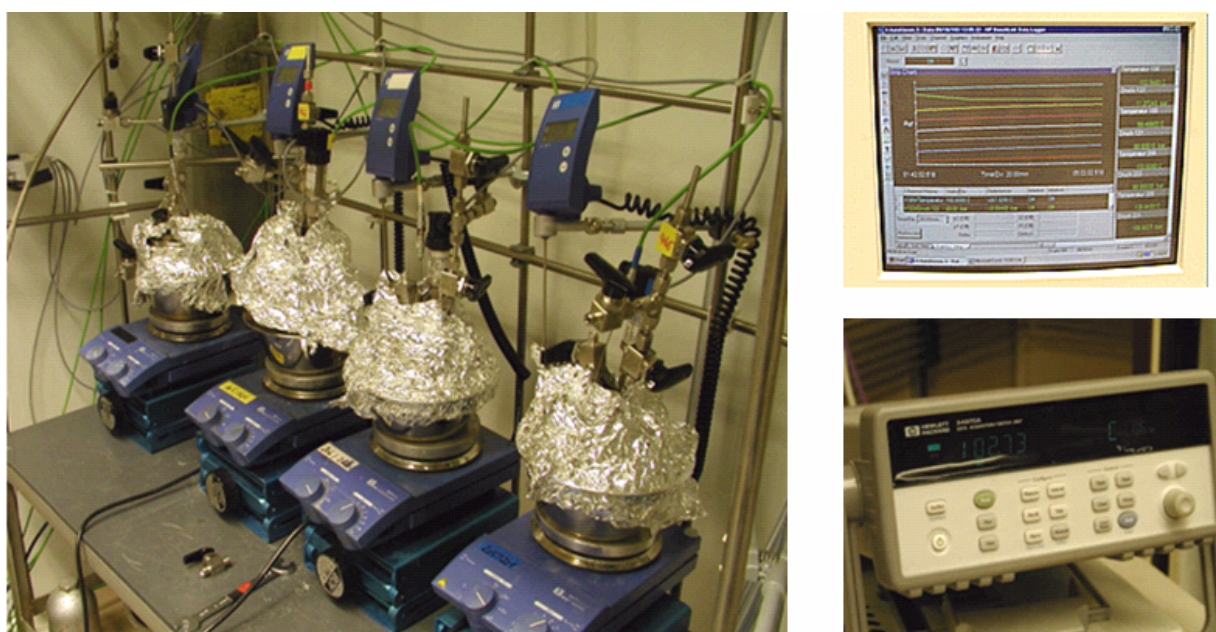
Abb. 21 Autoklaven mit Swagelock-Fittings (links, max. 250°C und 200 bar) mit Datenerfassung und Steuereinheit (rechts).
