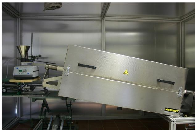
**Abbildung 3.6.:** Drehrohr der Firma Nabertherm für die Kalzinierung des Siliciumdioxidträgers. Die Kalzinierung erfolgte bei 400 °C und einer Verweilzeit von 10 min.
