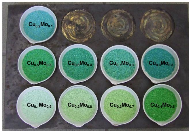
**Abbildung 3.9.:** Unkalzinierte Katalysatorproben mit steigendem Kupfergehalt P3700\_019\_CAL040-048.
