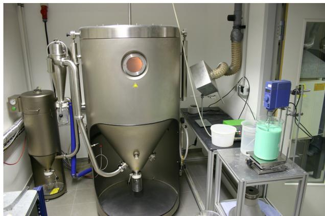
**Abbildung 3.10.:** Mobile Minor (TM); Sprühtrockner der Firma GEA Niro für die Trocknung der Kupfermolybdatlösung. Turmeintrittstemperatur:  $350$  °C; Turmaustrittstemperatur:  $120$  °C.
